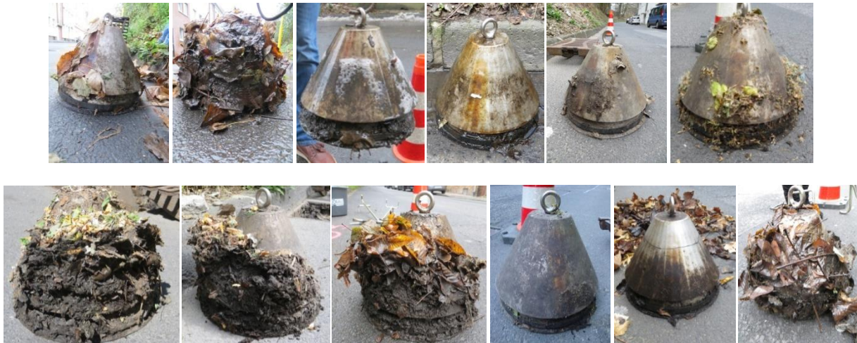
Abbildung 12: Sichtprüfung Verteilerkegel Anlage 1 November 2014 bis Dezember 2015
