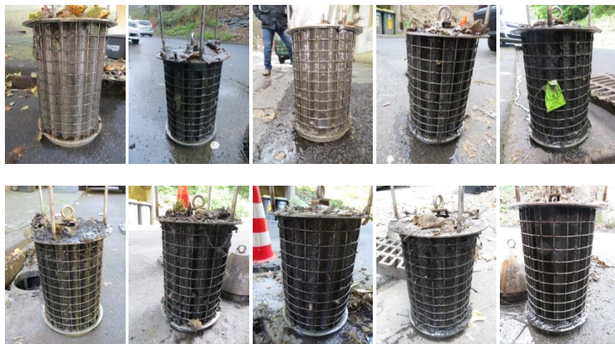
Abbildung 15: Sichtprüfung Filterpatrone Anlage 2 November 2014 bis Dezember 2015
