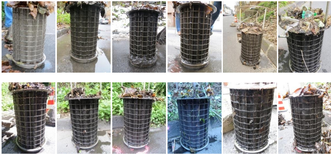
Abbildung 14: Sichtprüfung Filterpatrone Anlage 1 November 2014 bis Dezember 2015
