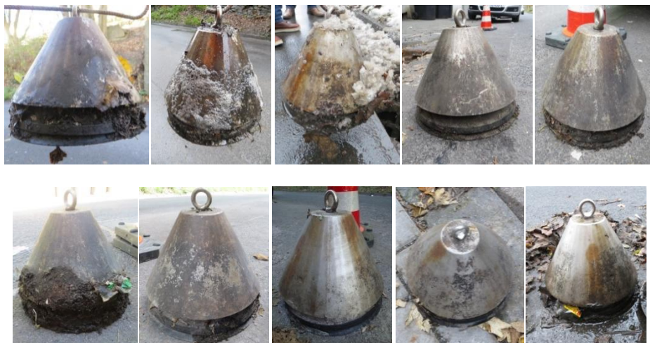
Abbildung 13: Sichtprüfung Verteilerkegel Anlage 2 November 2014 bis Dezember 2015
